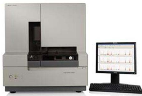
Рис. 80. Генетический анализатор AB 3130 (Applied Biosystems). Прибор используют для секвенирования и генотипирования по молекулярным маркерам
